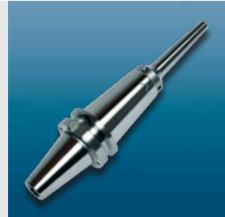
Das Power Mini Shrink Chuck ist ideal für die 5-Achs-Bearbeitung im Formenbau und in der Medizintechnik. An der Spitze sind sie extrem schlank, wie von unseren Mini Shrink Chucks gewohnt. An der Basis sind sie aber verstärkt. Dadurch ist auch bei langer Ausraglänge eine effiziente Fräsbearbeitung mit angestelltem Werkzeug möglich.
